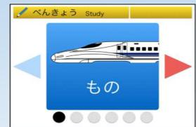
タッチパネルのボタンを大きくシンプルにすることで、操作しやすくなります。2度押しによる誤動作防止機能もついています。腕や手が不自由な子どもたちにとって、少々乱雑な操作をしても正しく反応します。
